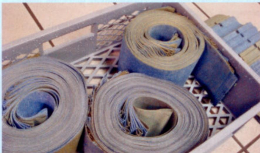
Die falsche Reinigungsmethode kann Schäden verursachen und beispielsweise die Beschichtung ablösen. Das Bild zeigt Vertikallamellen nach dem Waschen.
