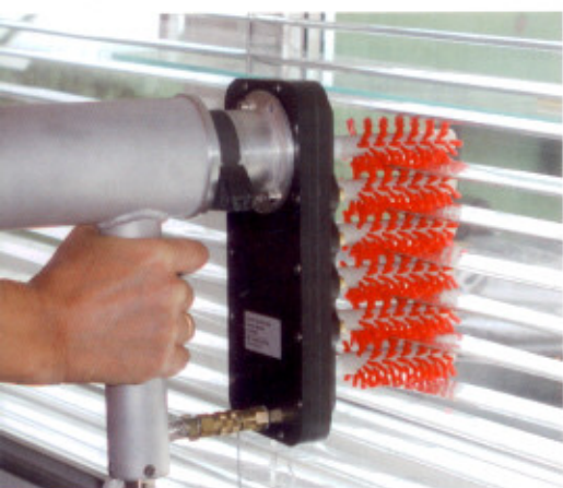
Die Reinigung mit Spezialbürsten schont die hochreflektierende Oberflächenbeschichtung von TLT-Jalousien
