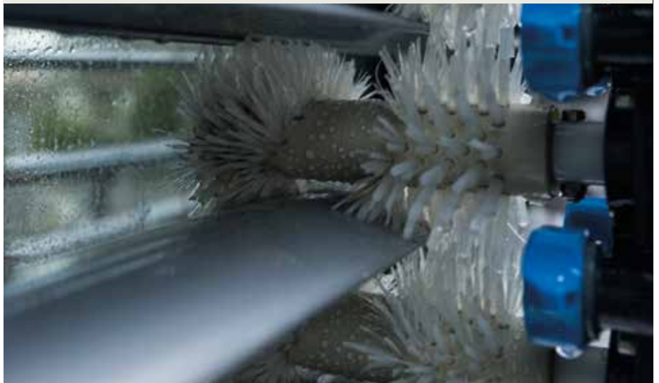
In einem Arbeitsgang werden die Lamellen gleichzeitig von unten und von oben gereinigt.
